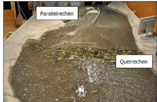
Abb. 2: Prinzip Tandemsystem (Quelle: Kurbericht Holzrückhalt Flüelabach Färich)
