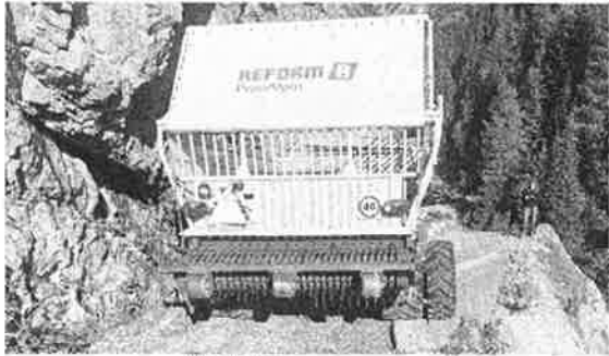
Durchfahrt eines Heuladers, welche die notwendige Breite der künftigen Mauer aufzeigte
