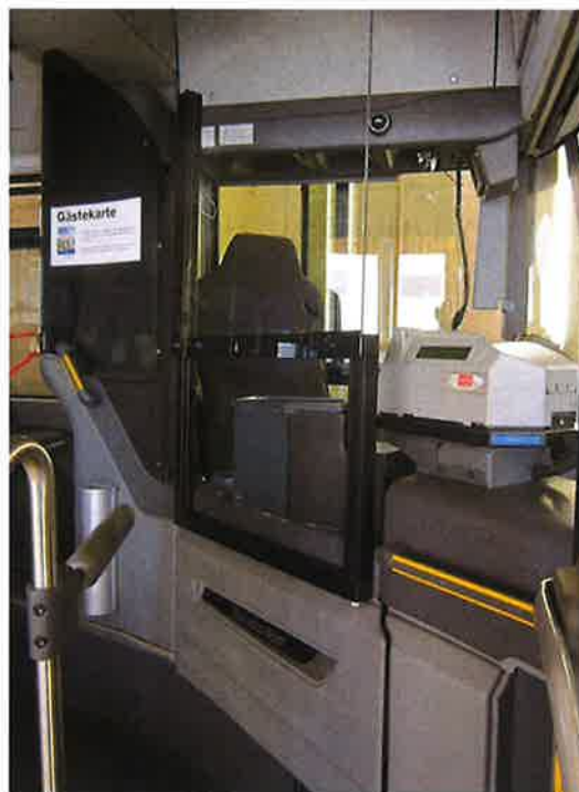
Neu montierte Fahrschutzscheibe
