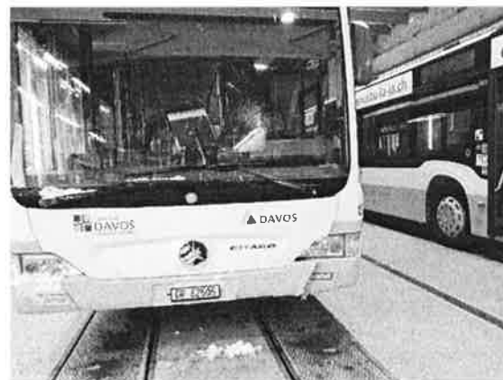
Defekte Busfront nach Rammung eines Pfostens der Strassenbeleuchtung
