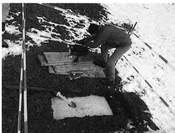
Färbversuch (gelb eingefärbtes Wasser) auf der Inneralp in Monstein
